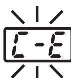
Когда возникает неисправность в работе датчика или нагревательного элемента (включая цепь датчика), на дисплее появляется оповещение **[5-E]** и электропитание отключается.
